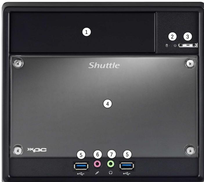
1. 5,25"-Schacht für ein optisches Laufwerk
