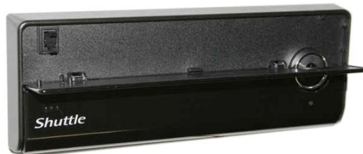
Der abgedeckte Laufwerksschacht.
