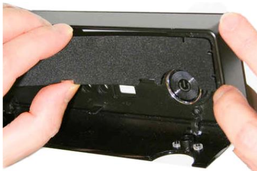
Installation des selbstklebenden Mylars
