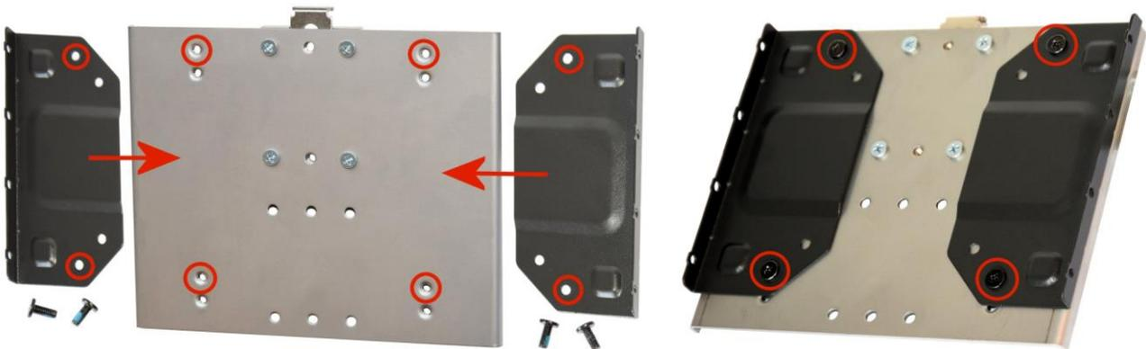
(3) Setzen Sie den Shuttle XPC in die VESA-Halterung und schrauben ihn seitlich mit vier M3-Schrauben fest. Danach kann das Gerät auf einer Hutschiene montiert werden.
